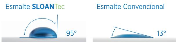
Para asegurar que las propiedades hidrofóbas y oleofóbas únicas del esmalte SloanTec fueran permanentes y pudieran hacer frente a las duras condiciones en los cuartos de baño comerciales, realizamos una serie de pruebas para envejecer artificialmente la superficie.
